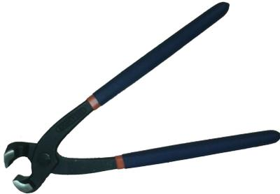
Las tenazas es una herramienta manual diseñada para sujetar, doblar o cortar. Posee un extremo cortante formado por dos elementos de forma curva que, son continuación de cada mango. Al realizar fuerza manualmente en éstos, ambas piezas curvas realizan, bien la acción de corte, o bien la acción de sujeción o extracción de la pieza a trabajar.
