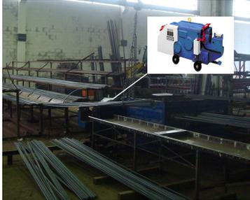
Se trata de una máquina accionada por un motor eléctrico que transmite la potencia a una bomba hidráulica, la cual se encarga de proporcionar caudal y presión para actuar sobre el elemento de corte.
