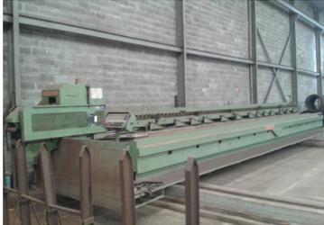
Esta máquina es manejada por un operario especializado. Conforme a las órdenes dadas por el operario a través de un programa informático, se introduce las barras de forma independiente y se efectúa el corte según las especificaciones requeridas, procurando generar el menor acero sobrante posible.
