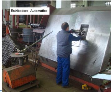
Esta máquina se utiliza principalmente para la realización de los cercos y estribos, por su complejidad. En el caso de tratarse de un proceso de conformación continua, en lugar de barras longitudinales, los estribos se crean a partir de bobinas (rollos) de acero corrugado. En función del diámetro de las piezas a conformar, se engancharán los rollos de acero necesarios.
