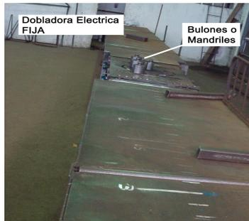
Esta máquina se utiliza cuando deben desarrollarse diversos dobleces o ángulos poco frecuentes en barras. Pueden ser fijas o móviles (dotadas de ruedas para el desplazamiento). Se coloca la barra sobre la superficie horizontal superior de la máquina, de forma que vaya pasando entre unas piezas cilíndricas intercambiables (**mandriles o bulones**). Este proceso se realiza en frío y a velocidad constante.
